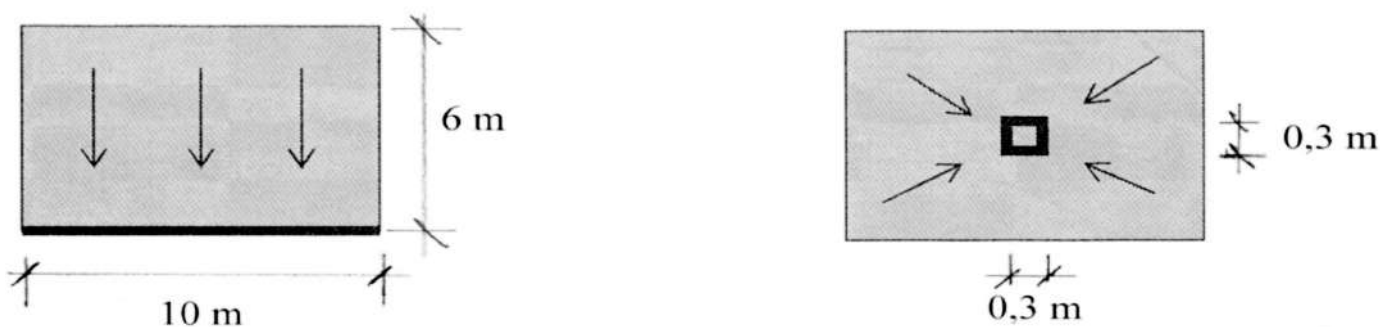
Obrázek 4: Odtoková šířka v případě okapového žlabu (vlevo) a vtoku (vpravo).
